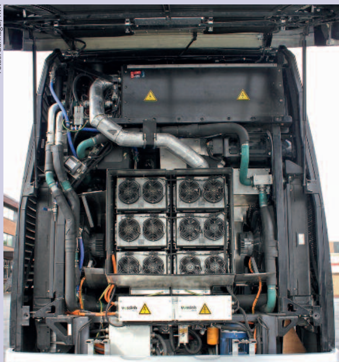
▲ Im schwarzen Koffer oben im Heck befindet sich die Brennstoffzelle, darunter sind die Supercaps von Maxwell zu erkennen
