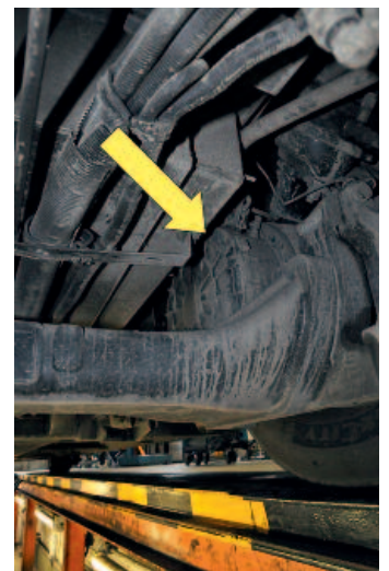
▲ Der Antrieb erfolgt beidseitig über je einen Elektromotor (hier in Fahrtrichtung rechts), der die Radnabe direkt antreibt, womit ein herkömmliches Getriebe entfällt
