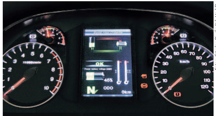
▲ Das Zentralsdisplay zeigt mittig die aktuell vorhandene Batteriekapazität an und ob gerade geladen oder Strom entnommen wird
