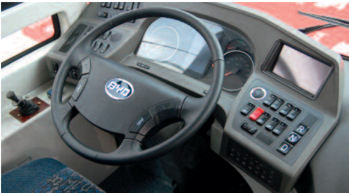
▲ Im Cockpit merkt man zunächst keinen Unterschied zum Dieselbus, zumal die Schalter (rechts) denen einer Wandlerautomatik gleichen
