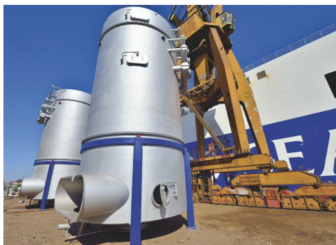
▲ Die Scrubber von Alfa Laval vor dem Einbau auf einer DFDS-Fähre
