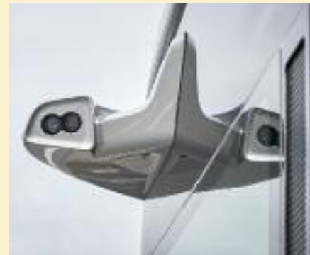
↑ Mehr als ein Dutzend Kameras beobachtet die Umgebung des Busses Foto: Daimler AG
