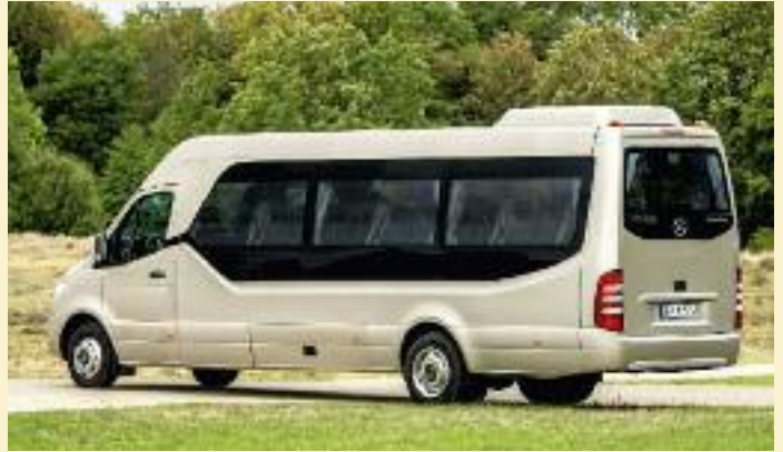
🔴 Der Sprinter Travel 75 verfügt über einen Radstand von beachtlichen 5 100 mm und bietet bis zu 21 Passagieren Platz Foto: Daimler AG
