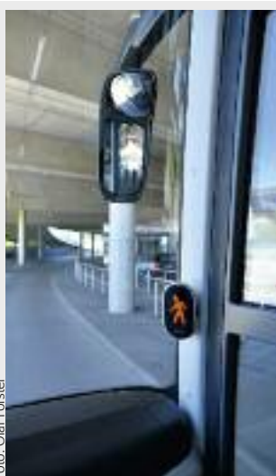
↑ Das Mobileye-Shield-Plus-System warnt optisch an der A-Säule vor Fußgängern
