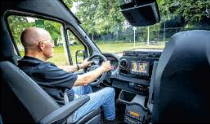
🔴 Das Cockpit im Sprinter Travel stammt vom Transporter, nur die Schalterreihe auf der Mittelkonsole ist busspezifisch Foto: Daimler AG
