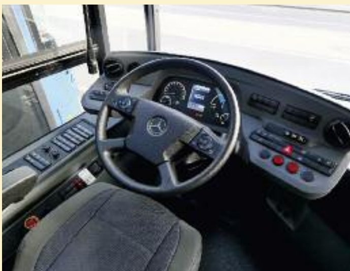
↗ Das Farbdisplay zwischen den Uhren wird über das Multifunktionslenkrad gesteuert (linkes Bild). Beide Cockpits sind tadellos, das des MAN wirkt etwas gemütlicher und voller (rechtes Bild) Fotos: Daimler AG, Olaf Forster
