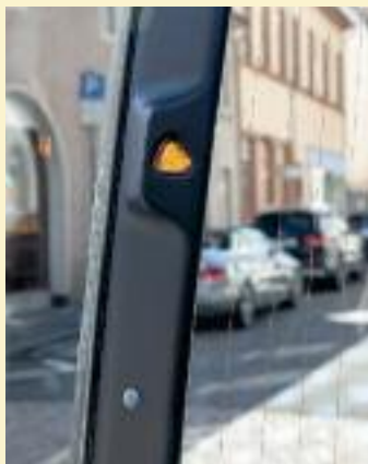
↑ Eine kleine Warnleuchte in der A-Säule warnt beim eCitaro vor potentiellen Gefahren Foto: Daimler AG
