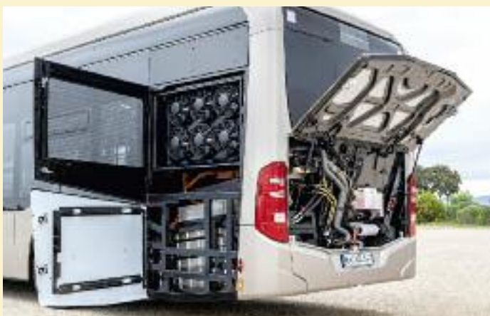
Der nunmehr eigentlich überflüssige Motorturm nimmt beim Citaro einen Teil der Batterien und der E-Technik auf (links). Der Synchron-Zentralmotor des MAN mit 240 kW und 2 100 Nm schickt seine Kraft über eine Kardanwelle an die konventionelle Portalachse (rechts die Verkabelung im ehemaligen MAN-Motorraum) Fotos: Daimler AG, Olaf Forster
