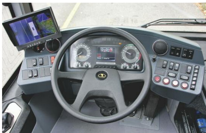
▲ Das Cockpit kann auch in VDV-Ausführung geliefert werden. Schön: der hilfreiche Fahrermonitor. Nicht ganz up to date: das stehende Gaspedal
