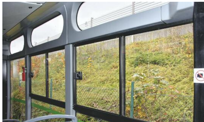
▲ Ungewöhnliche Lösung: kleine, abgerundete Fenster am Dach sowie manuelle zu betätigende Schiebefenster für die Fahrgäste
