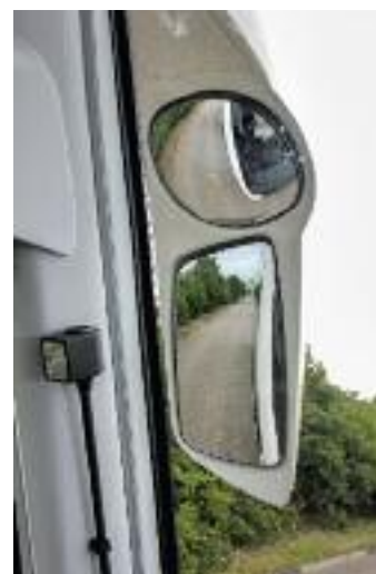
↑ Die hoch angebrachten Außenspiegel ohne Kopfstoßgefahr bieten eine gute Übersicht. Im Testbus neigte der linke Spiegelarm allerdings zu einem unschönen Zittern bei Straßenunebenheiten
