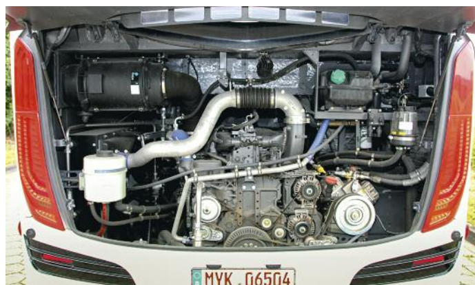
↑ Einen aufgeräumten Eindruck macht das Heckmodul mit den Antriebsaggregaten, die bis zu 462 PS leisten
