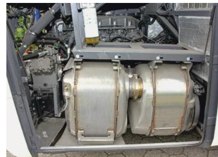
↑ Da ist noch Luft: Alle Aggregate vom Motor bis zu den Abgasnachbehandlungssystemen sind sehr gut zu erreichen
