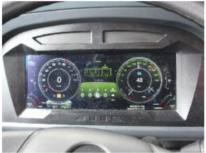
⬆️ Nach rund zwei Minuten Schnellladen mit 250 kW war der Ladestand schon wieder von unter 60 % auf 74 % angewachsen, die Reichweite auf 48 km gestiegen Foto: Bünnagel
