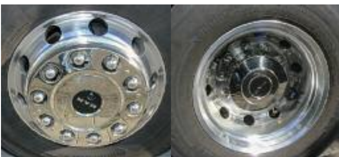
Auch die Alufelgen tragen zur Gewichts- und damit Verbrauchsminderung bei. Sie sind insgesamt knapp 90 kg leichter als Stahlfelgen
