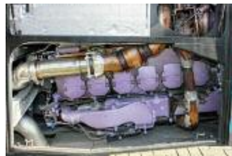
↑ Unverkennbar liegend, und zwar links im Heck: der Sechszylinderreihenmotor MAN D2066 nebst Abgasnachbehandlungstechnik
