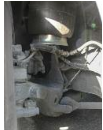
Die typische MAN-Starrachse vorne bleibt dem Lion's City auch nach der Modellpflege erhalten
