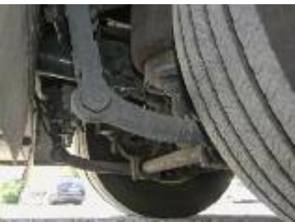
▲ Schmale Federträger, dafür aber Stabi an der Hinterachse
