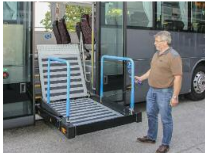
▲ Die günstige und ebenso praktikable Lösung für den Behinderten-transport im Hochbodenbus: der Kassettenlift am Einstieg 2
