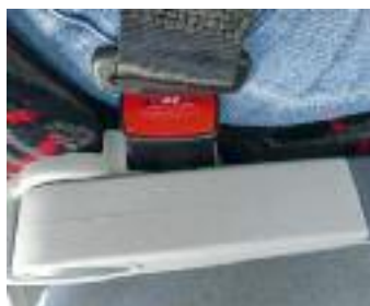
▲ Unschön: Die Gurtschlösser stehen am Sitz hoch und stören beim Hinsetzen und Aufstehen
