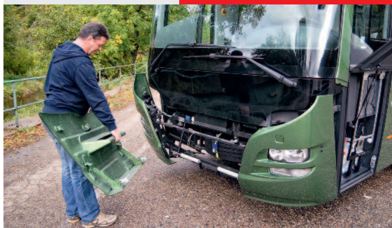
▲ In drei Teilen oder als Ganzes zu öffnen: die neu gestaltete Bugverkleidung des Regio
