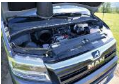
↗ Angetrieben wird er TGE serienmäßig von einem 2-l-Vierzylinder-Diesel Foto: Olaf Forster
