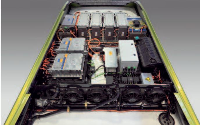
▲ Hochspannung auf dem Dach des Hybridbusses: Supercap-Module (insgesamt 6, Reihe ganz vorn) und Leistungselektronik
