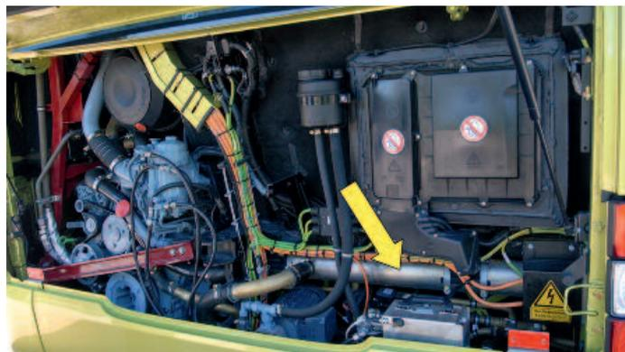
▲ Blick in den Motorraum des Lion's City Hybrid, der zum großen Teil mit Elektrotechnik gefüllt ist – darunter auch der „Tauchsieder“ (Pfeil), ein Widerstand zum Abbau von überschüssiger Bremsenergie
