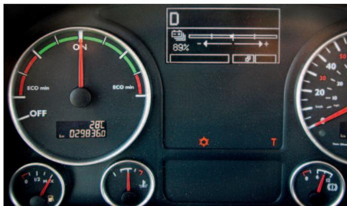
▲ Anstelle des Drehzahlmessers ist im MAN-Hybridbus eine Effizienzanzeige installiert (links). In der Mitte befindet sich zusätzlich die Ladekontrolle für die Supercaps
