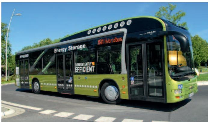
▲ Auffallende Optik mit schwungvollen Linien: Das „EfficiencyDesign“ des Daches verdeckt Speicher und Peripherie für den Elektroantrieb
