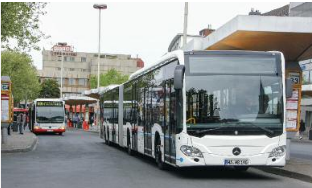
↖ Um die enge Ausfahrt rechtsseitig nehmen zu können, ohne mit dem Heck den Haltestellenbereich abzuräumen, muss der Großraumgelenkbus am Bonner ZOB etwas entfernt vom Bordstein halten
