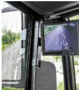
↪ Praktisch: die Monitorbilder der Seitenkameras, die hinter dem Gelenk sitzen
