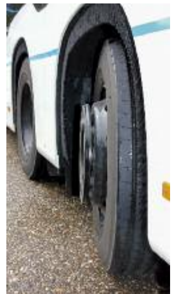
↖ Die gelenkte Nachlaufachse erleichtert das Manövrieren mit dem Großraumbus
