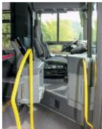
↖ Die Kabinenfahrtür öffnet so nach außen, dass ein möglicher Angreifer nicht auf direktem Weg von hinten zum Fahrer vordringen kann und dieser durch den geöffneten Flügel der Tür 1 entfliehen kann, während der andere geschlossen bleibt – eine Neuerung im CapaCity
