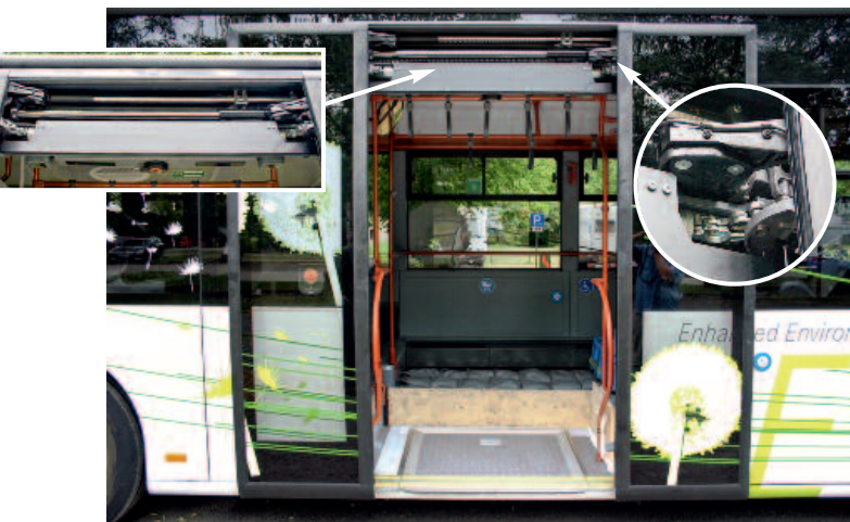
▲ Nur 2,5 Sek. benötigen die beiden zweiflügeligen Schwenkschiebetüren für die Öffnung – rekordverdächtig. Dafür und für die sichere Funktion sorgt die Elektrik in Kombination mit einer Pneumatikverriegelung (siehe Detailfotos)
