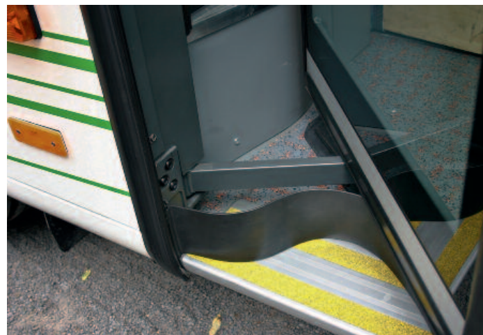
▲ Neues auch bei der vorderen Innenschwenktür: Sie ist stehend auf einem Kugelkopf montiert, nicht mehr hängend. Damit lässt sie sich nicht nur besser einstellen, sondern auch mit einer wartungsfreundlichen Gummibanddichtung versehen (unten)
