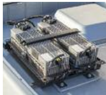
↑ Zwei Supercapmodule und der Wechselrichter verborgen sich hinter den Dachaufbauten am Heck Foto: Daimler AG
