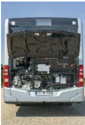
↑ Im Heck werkelt natürlich weiterhin der OM 936 G in stehender oder liegender Ausführung Foto: Daimler AG
