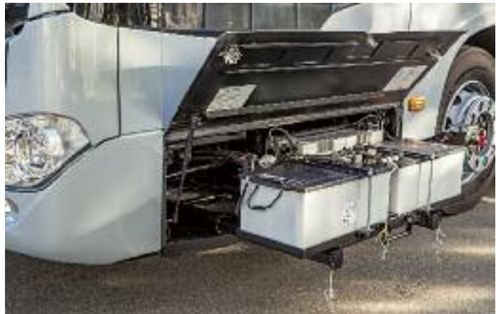
↑ Neben den beiden Supercapmodulen auf dem Dach findet sich eine dritte Einheit von Doppelschichtkondensatoren hinter den beiden 12-V-Batterien. Diese Anordnung ist bereits aus dem Diesel-Citaro bekannt Foto: Daimler AG
