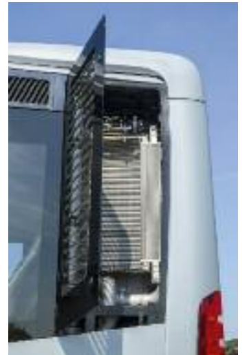
↑ Das Niedertemperaturkühlsystem für die Supercaps ist linksseitig vor der Hecksäule und direkt hinter dem Motor-kühler untergebracht Foto: Daimler AG
