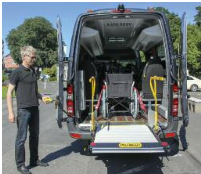
↑ In handgestoppten 24 Sekunden war der Unterflurlift komplett ausgefahren
