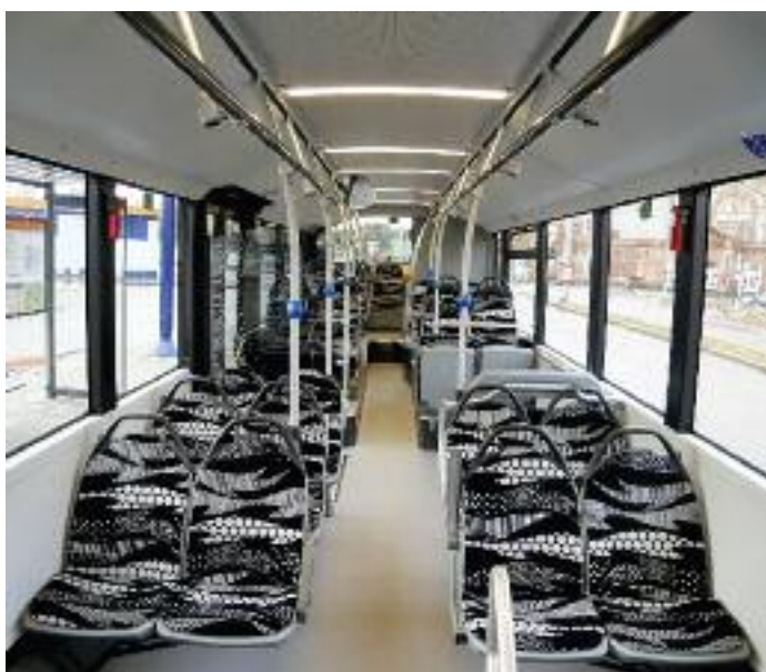
↑ Der eCitaro zeigt sich innerlich weitgehend brav – bis auf die frisch eingezogene Innendecke mit neuen Leuchtmodulen Fotos: Olaf Forster
