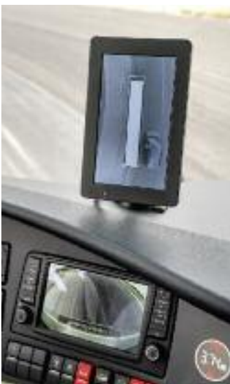
360-Grad-Bird-View-System erlaubt den Blick übers komplette Fahrzeug Foto: MAN
