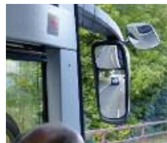
↑ Der Ulyso T überwacht den Verkehrsraum noch mit Spiegeln. Die Einführung von Kamera-Monitor-Systemen ist noch nicht geplant
