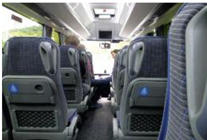
Bis zu 34 Passagiere kann der 10-m-Bus aus türkischer Produktion aufnehmen. Die Sitze verfügen über Handy-Steckfächer und USB-Schnittstellen (rechts) Fotos: Sanne
