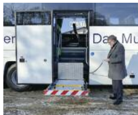
↑ Ein Lift am Mitteleinstieg hilft beim „Verladen“ von Rollstühlen
