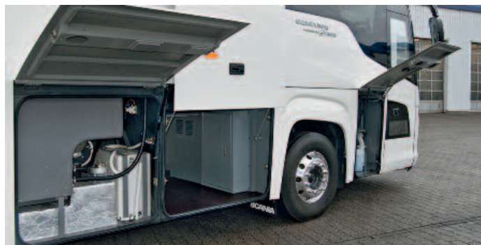
▲ Die Klappe neben dem Einstieg zwei gewährt den Zugang zu den Anschlüssen des WC-Einbaus sowie zum Wasserbehälter
