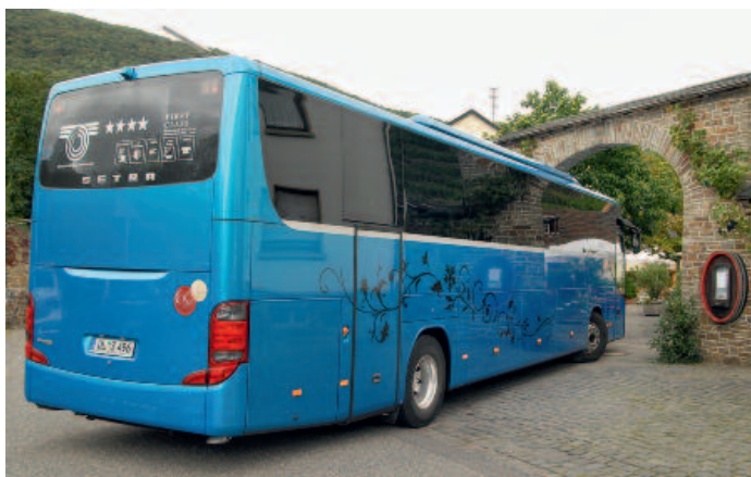
▲ Der lange Radstand verlangt zwar besondere Beachtung hinsichtlich Ausschwenkmaß und Wendigkeit, was jedoch nicht grundsätzlich bedeutet, dass dem Setra enge Tore versperrt sind
