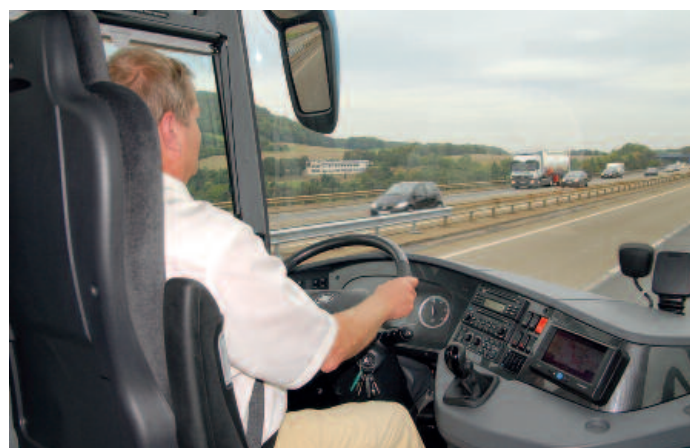
▲ Der Fahrerarbeitsplatz im Setra 416 GT-HD/2 überzeugt mit guten Platzverhältnissen und übersichtlicher Anordnung von Schaltern und Anzeigen. Rechts an der Scheibe die Messinstrumente für Spurassistent und Licht-/Regensensor
