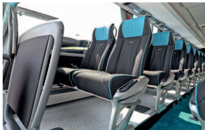
▲ Voyage-Plus-Sitze mit verbesserter Verstellung der Sitzlehnen. Insgesamt handelt es sich im Testbus um eine komfortable Ausstattung mit ausgefallener Farbgebung
