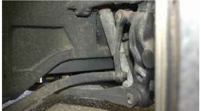
↑ Die Einzelradaufhängung an der Vorderachse ist mit Doppeldreieckslenkern realisiert
