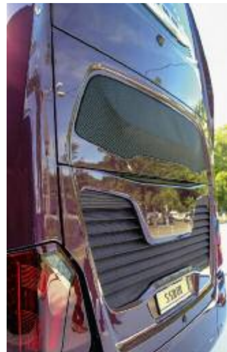
↑ Schick präsentiert sich das Heck mit originellen Formen und den Lüftungsgittern zum Motor und der Klimaanlage
