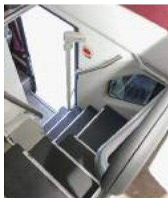
↑ In Ordnung, aber nicht so elegant gelöst wie im Neoplan Skyliner: der hintere Aufstieg. Größere Menschen müssen beim Auf- und Absteigen den Kopf einziehen, um nicht oben anzuschlagen Foto: Bünnagel
