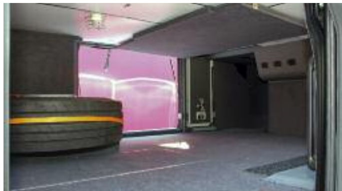
↑ Kaum größer als der Vorgänger ist der Kofferraum mit Rauchmelder. Das Reserverad kann auch hinter der rechten Vorderachse Platz finden oder ganz entfallen Foto: Bünnagel
