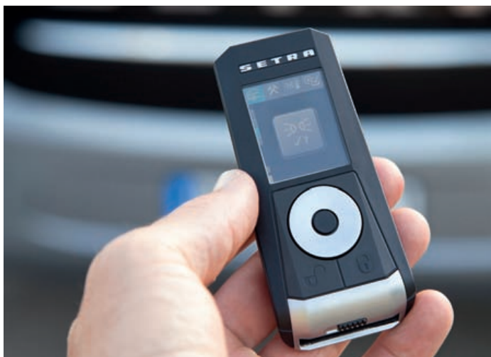
▲ Der neue Multifunktionsschlüssel soll dank zahlreicher Features eine Abfahrtskontrolle ohne Gang um den Bus ermöglichen
