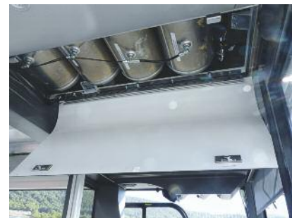
▲ Die Luftdruckbehälter sind nunmehr im Einstiegsbereich unter dem Dach montiert und daher sehr gut zugänglich
