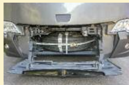
⬆️ Hinter der per Hebel abklappbaren Bugmaske ist das Reserve- rad nun besser erreichbar
