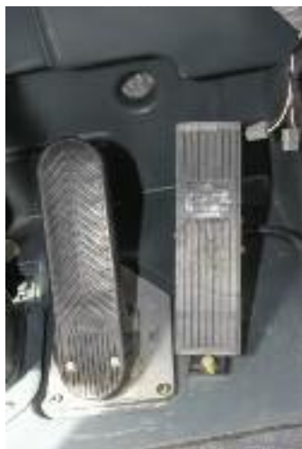
▲ Ungeliebt bei vielen Fahrern: stehende Pedale. Unschön sind auch die offenen Verkabelungen im Fußraum
