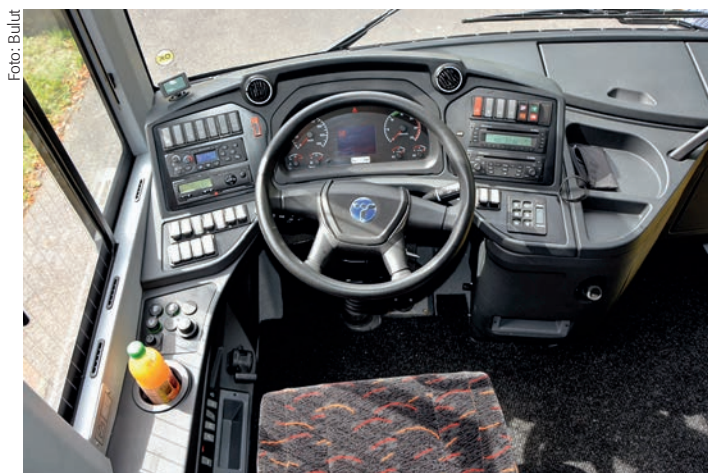
▲ Der Fahrerarbeitsplatz ist klar strukturiert: Klimasystem und Tachograf sitzen links, Radio und CD-Spieler rechts neben dem Lenkrad
