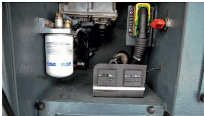
▲ Dank der Zähluhren für die Laufzeit von Klimaanlage und Zusatzheizung lässt sich der Teilverbrauch von Diesel zwecks Erstattung der Energiesteuer einfacher belegen
