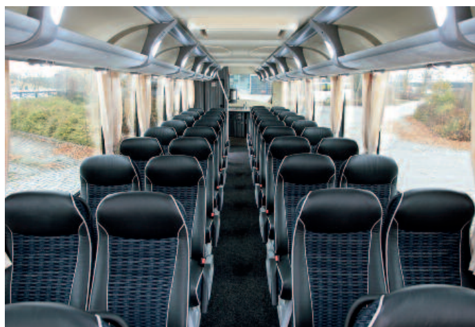
▲ Komfortabel und hell ist der Fahrgastraum des 12 m langen Viseon HD mit Kiel-Bestuhlung im 4-Sterne-Abstand
