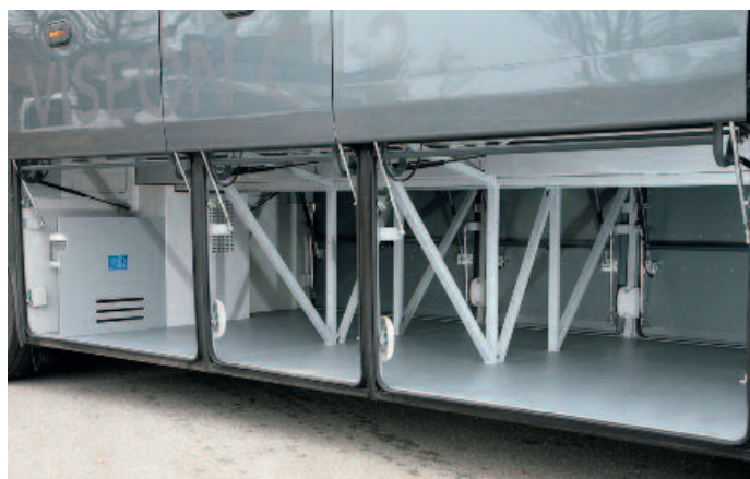
▲ Der große Kofferraum (10,5 m 3 ) konnte in diesem Umfang nur durch den HeckEinstieg umgesetzt werden. Gut zu sehen: Der Raum über der Achse (l.) wurde für einen zusätzlichen kleinen Stauraum genutzt
