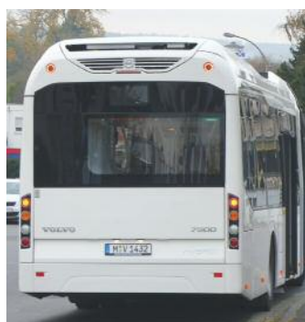
▲ Bei der Heckansicht erkennt man erst auf den zweiten Blick, dass es sich hier um einen dieselelektrischen Hybridbus handelt
