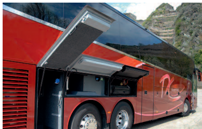
▲ Sicher und getrennt zugänglich: die Tanks für Diesel (r.) und AdBlue (Mitte), mit jeweils eigener Klappe. Links daneben befindet sich eines der zusätzlichen Staufächer
