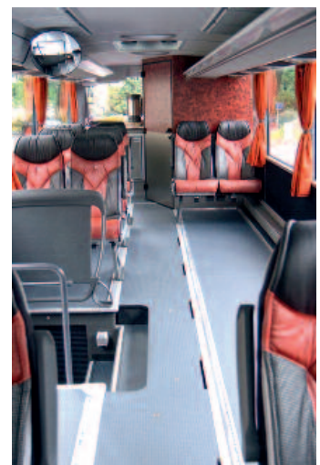
▲ Durch zwei Rollstuhlplätze fallen mindestens sechs bis acht Sitzplätze im Fernlinien- bzw. Reisebus weg
