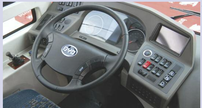
▲ Im BYD-Cockpit merkt man zunächst keinen Unterschied zum Dieselbus, zumal die Schalter (r.) denen einer Wandlerautomatik gleichen
