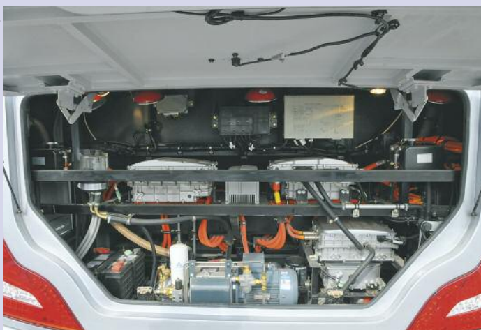
▲ Im Motorraum des Chinesen finden sich ausschließlich elektrische Aggregate und Verbindungen zu den dahinter integrierten Batterien
