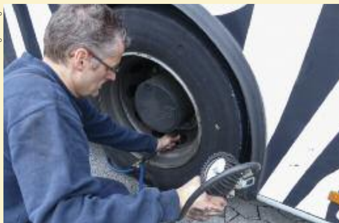
☛ Sorgfältig wurde bei jedem Fahrzeug der Reifendruck gemessen und wenn notwendig angepasst, um gleiche Bedingungen zu schaffen
