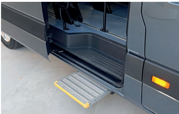
▲ Eine elektrisch ausfahrbare Stufe erleichtert den Passagieren den Einstieg in den Fahrgastraum Foto: Hyundai
