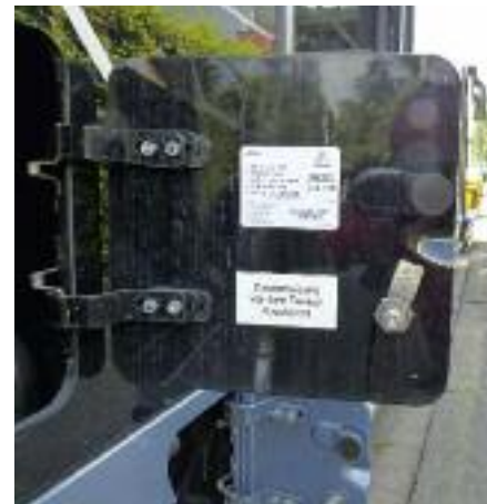
↑ Nur Diesel (EN 590) darf getankt werden. Alternative Kraftstoffe wie Biodiesel sind nicht zugelassen
