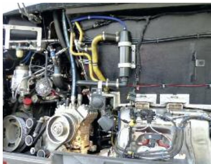
↑ Blick in den Motorraum: Der D15 liefert in diesem Fall 280 PS
