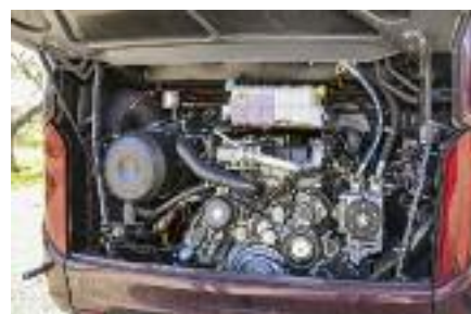
460 PS und 2 300 Newtonmeter stellt der D26-Motor im 13-m-Modell bereit
