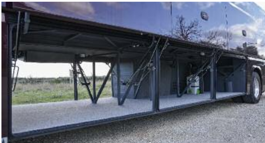
↗ Bis zu 14,3 m 3 Ladevolumen stehen maximal zur Verfügung
