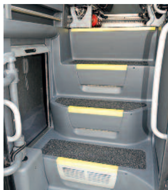
▲ Einstieg 2 mit beleuchteten und ordentlich markierten Stufen, links der Zugang zur Schlafkabine
