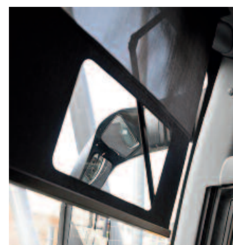
▲ Sehr schön: Sichtfenster im durchgehenden Sonnenrollo sorgen für freie Sicht auf den rechten Außenspiegel
