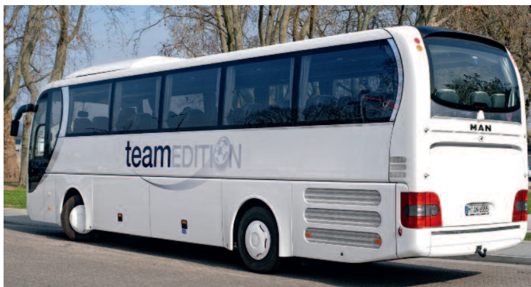
▲ Ansprechendes Design: Der Bogen vorne vor dem Übergang zum Fahrerplatz wiederholt sich im Heck des Lion's Coach. Der winzige Dachspoiler über dem Heckfenster soll Kraftstoff einsparen
