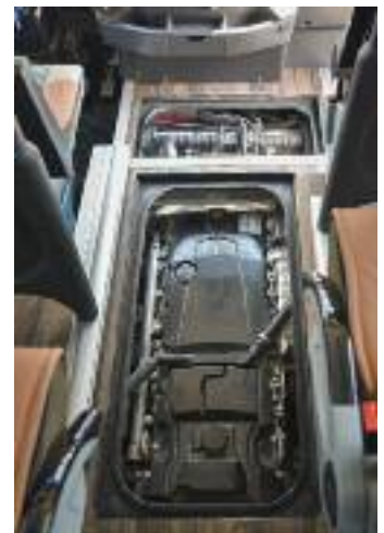
↖ Der Motor verschwindet unter dem Laufgang und ist über Serviceklappen im Boden zu erreichen
