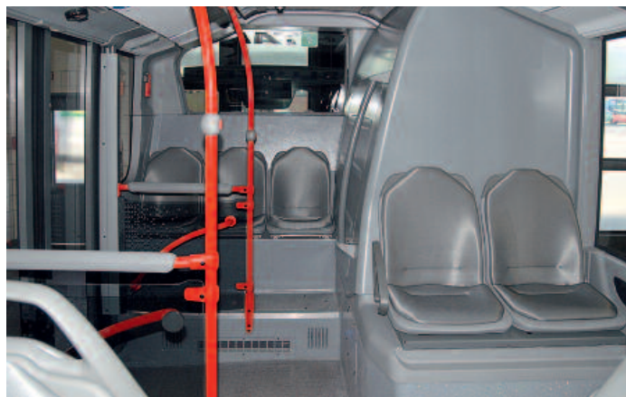
▲ Sitzanordnung im Citaro mit Hecktüre und stehendem Motor. Bei liegendem Motor fällt der Turm kleiner aus, wodurch sich bis zu sechs Sitzplätze mehr ergeben, wenn zugleich auch die Hecktür entfällt
