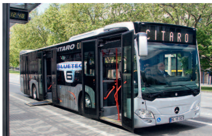
▲ Neu beim Citaro 2 mit Euro-6-Antrieb ist u. a. die durchgehende Einstieghöhe von 320 mm. Dadurch lässt sich der Druckluftverbrauch durch Kneeling um 10 bis 20 Prozent reduzieren, was ein halbes Prozent Kraftstoff einsparen soll
