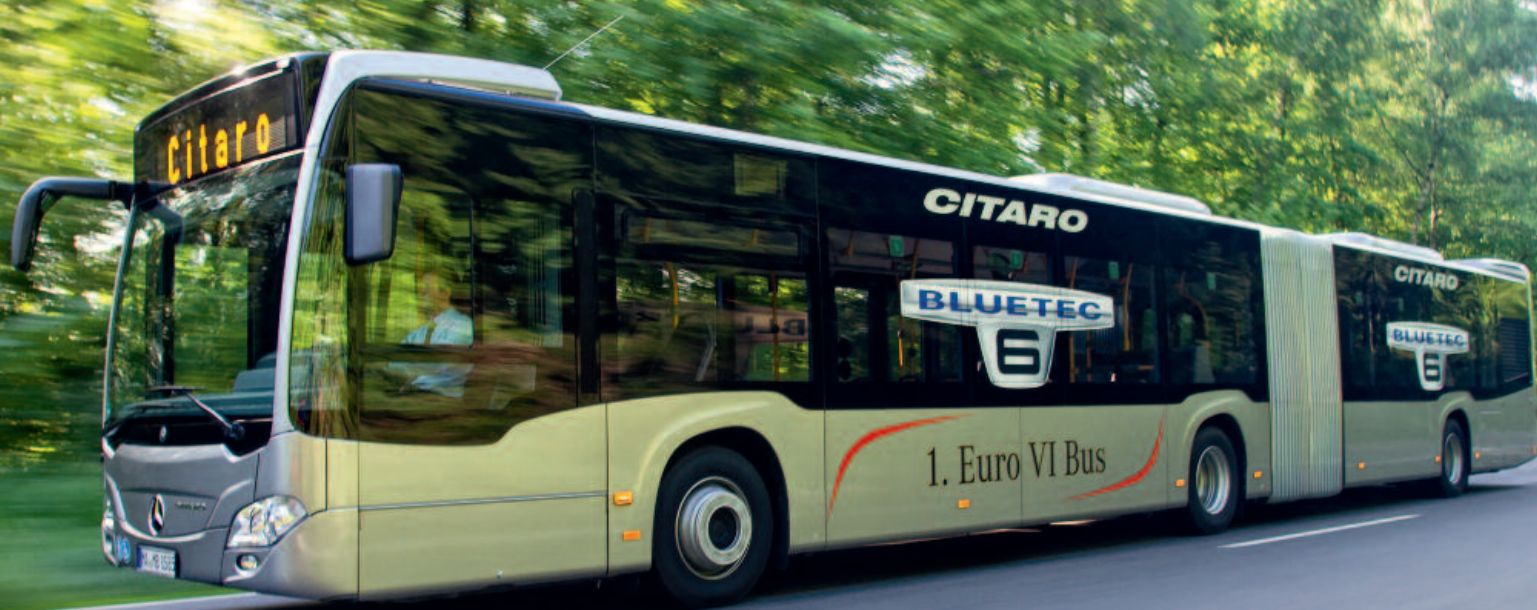
Der Citaro-Gelenkbus mit 360 PS starkem Euro-6-Motor zeigte sich durchzugsstark schon bei niedrigen Drehzahlen
