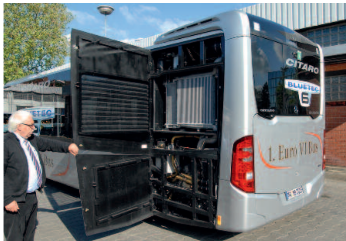
▲ Alle Motoren werden in Turmbauweise angeordnet. Im oberen Teil findet das Kühlsystem Platz, unter der Dachhaube ist der dazugehörige Nachfüllbehälter untergebracht
