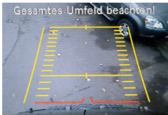
▲ Eine sehr gute Hilfe beim Rangieren bietet die Rückfahrkamera plus Parktronic des Sprinters: Die gelbe Markierung zeigt den eingeschlagenen Weg, die rote die Heckbegrenzung des Fahrzeugs
