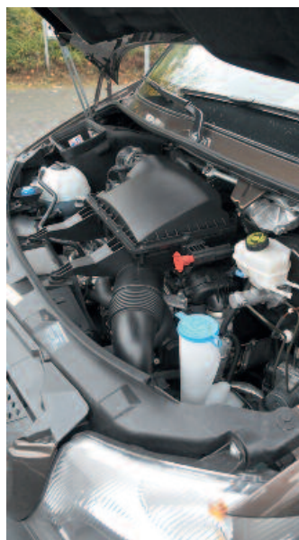
▲ Der enge Innenraum begrenzt den Blick auf den V6 sehr. In Fahrtrichtung rechts vorne sitzt der blaue Einfüllstutzen für den AdBlue-Tank
