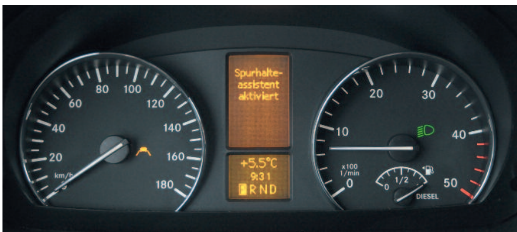
▲ Der Spurhalteassistent ist ab 60 km/h aktiv; er lässt sich deaktivieren Fotos: Görgler
