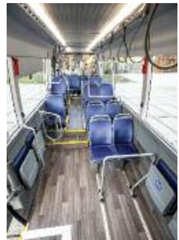
Der vordere Wagenteil ist als Niederflurbereich ausgelegt
