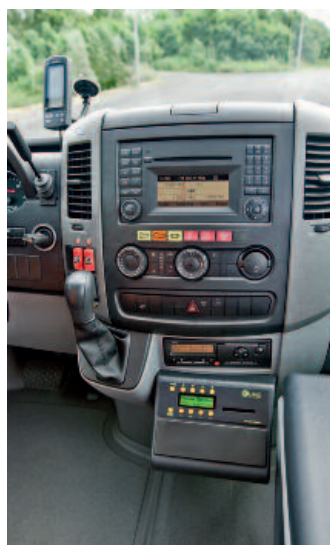
▲ Die typischen Sprinter-Armaturen wurden um Funktionsschalter für den Busbetrieb ergänzt. Neu ist die Platzierung des Retarderhebels rechts neben dem Tourenzähler
