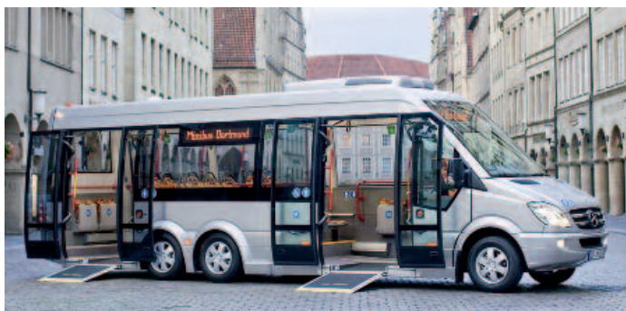
◀ Durchgehend Niederflur, zwei Doppeltüren und zwei Plattformen: Der City 77 beeindruckt durch Konzept und Erscheinung
