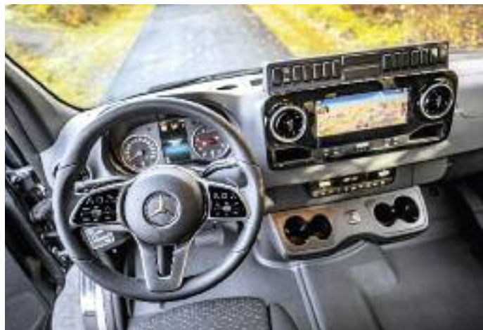
↪ Das neue Multimedia-System MBUX besitzt im Armaturenbrett einen sieben oder 10,25 Zoll großen Touchscreen
