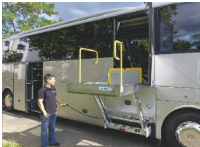
▲ Der elektrisch ausfahrbare Rollstuhllift (Göbel 300) gewährleistet einen stufenlosen Zustieg über eine separate Schlagtür. Künftig sind zwei Rollstuhlplätze in Fernlinienbussen vorgeschrieben Foto: Görgler
